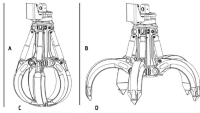
Die RPG-Serie gibt es mit vier oder fünf Schalen. Die Form der Schalen ist wahlweise offen, halboffen oder geschlossen. Auf diese Weise kann ein Polypgreifer von Rotar für verschiedene Anwendungsbereiche eingesetzt werden.
